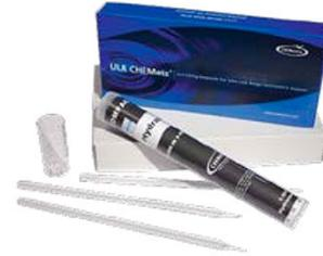
Die Farbintensität wird visuell mit einem Farbkomparator abgeglichen, um die DO-Konzentration zu bestimmen. CHEMetrics bietet auch eine Komparator-Lichtquelle (CLS) für den Einsatz bei schlechten Lichtverhältnissen an. Ein Video, das die Verwendung der DO-Testkits von CHEMetrics veranschaulicht, ist auf den DO-Produktseiten unter [www.wasseranalyse.shop](http://www.wasseranalyse.shop) verfügbar.
