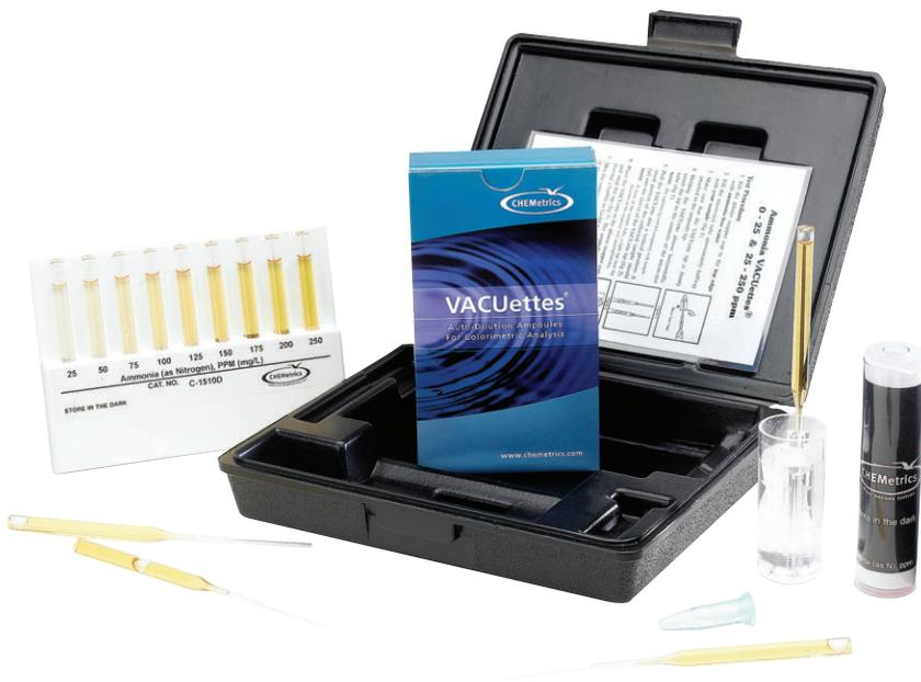
VACUettes Ampullen sind für konzentrierte Proben. Sie verwenden eine patentierte Autoverdünnungsfunktion, die die Notwendigkeit von ein zeitaufwändiger und fehleranfälliger manueller Verdünnung eliminiert. Infolgedessen dauert der gesamte Test typischerweise nur 2 bis 3 Minuten, bei einer vergleichbaren Genauigkeitsrate zu einem volumetrischen Verfahren. Der Grundaufbau dieser 7 mm Ampullen ist der gleiche wie bei den CHEMets-Ampullen, jedoch ist eine Kapillarspitze an der Spitze jeder Ampulle.
