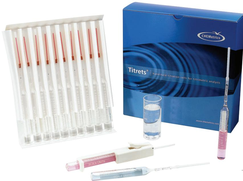
Jede Titret-Ampulle hat einen Durchmesser von 13 mm und ist für die titrimetrische Analyse konzipiert. Die Ampulle enthält vakuumversiegeltes flüssiges Titriermittel und ist mit einer flexiblen Ventileinheit versehen.
