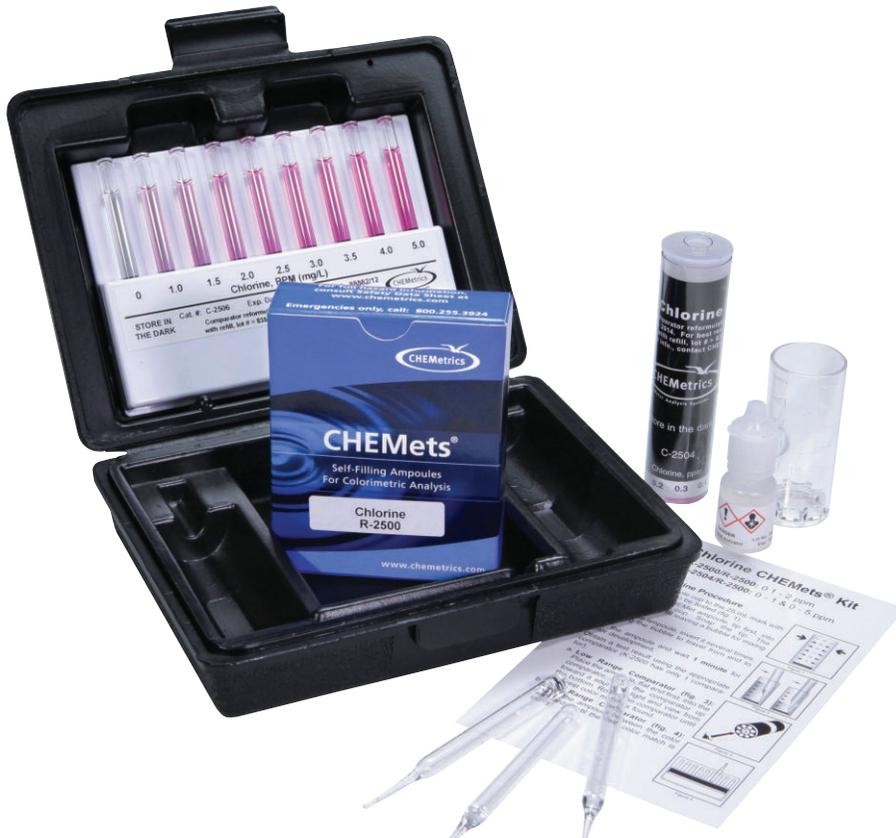
Die Kits enthalten 30 Ampullen, Komparator(en), Zusätzliche Lösung(en) (falls erforderlich), einen Probenbecher und eine Anleitung. Nachfüllpackungen mit 30 Ampullen und zusätzliche Lösungen sind separat erhältlich. Die Haltbarkeit der Komparatorlösung(en) beträgt mindestens 1 Jahr.
